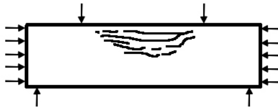
Figura 11. Fisura por flexión simple.
