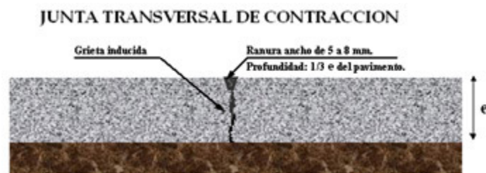
Figura 23. Junta de Contracción.
