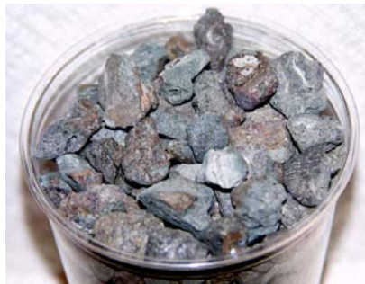
Fig 03. Muestra de pizarra expandida
