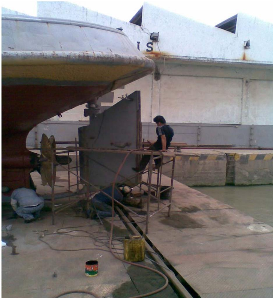
Figura 10.- Desmontaje de un sistema de gobierno
