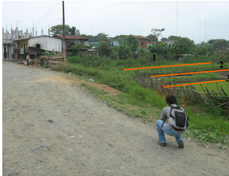
Foto # 5.7. Medición con cinta del ancho del paleocauce Río Seco de Baba, en el poblado de Baba. (Muñoz-Guaranda, 2008). Los números 1, 2 y 3 indican la terraza superior, terraza más baja y nivel actual respectivamente.
