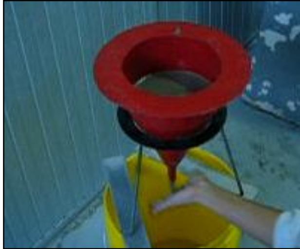
FIGURA 5.1 MEDICION DE FLUIDEZ DE CONO
