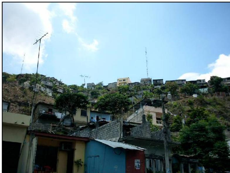
**Foto 12.-** *Presencia de casas construidas en laderas que tienen la pendiente en el mismo sentido de la estratificación con riesgo inminente a deslizamiento.*
