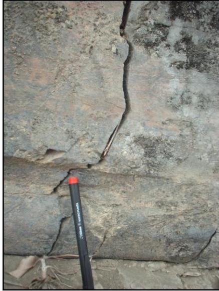
**Foto 5.-** Presencia de fracturamiento en lutitas, en la fotografía separación entre paredes aprox. 6 mm, sin relleno.
