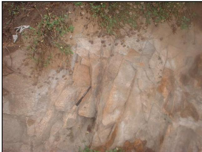
**Foto 3.-** Afloramiento de granodiorita, a la altura de Pascuales (Vía Perimetral) en las coordenadas 9771651 N/620250 E.
