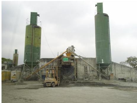
**FIGURA 5.14 Dosificación en planta del hormigón liviano**
