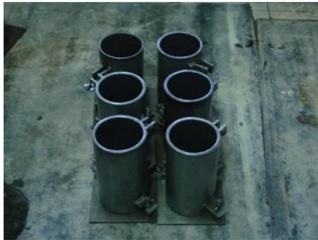
**FIGURA 4.9 Moldes metálicos cilindros de 100x200mm**
