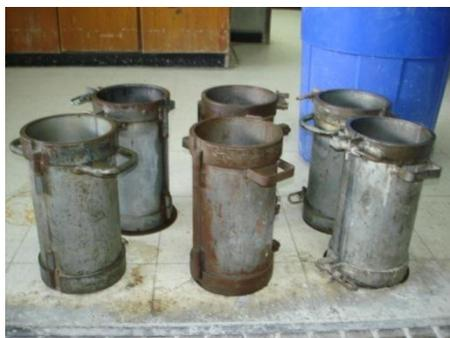
**FIGURA 4.10 Moldes metálicos cilindros de 150x300mm**
