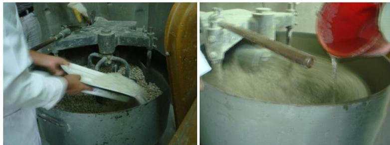
**FIGURA 4.5 Colocación de los materiales y las 2/3 partes de Agua a la mezcla**
