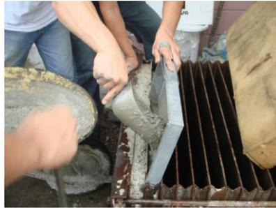
**FIGURA 5.2 Colocación del hormigón liviano en el molde**
