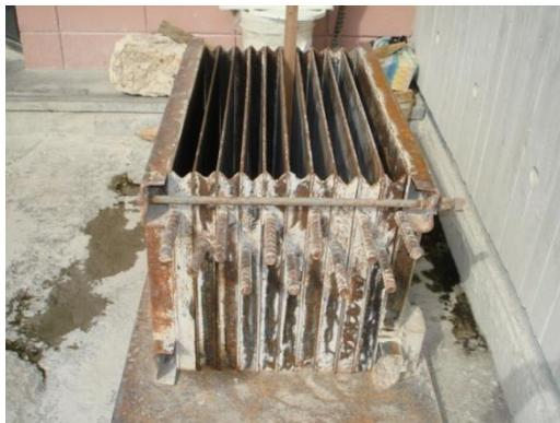
**FIGURA 5.1 Molde para la elaboración de paneles**
