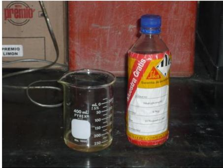
**FIGURA 4.3 Pesaje del Aditivo incorporador de aire**
