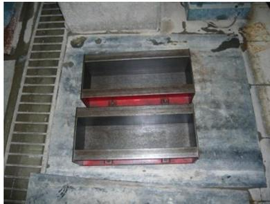
**FIGURA 4.11 Moldes metálicos vigas de 150x150x500mm**
