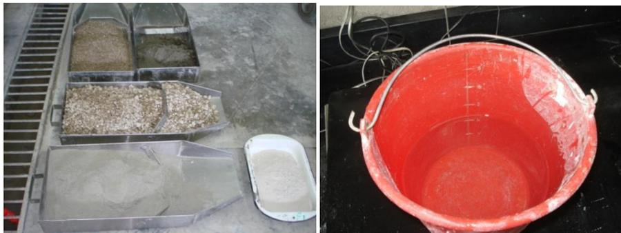
FIGURA 4.1 Cemento, Agregados, Filler y Agua para la mezcla
