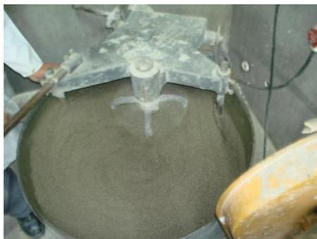
**FIGURA 4.8 Mezcla de Hormigón Liviano con Agregado volcánico**
