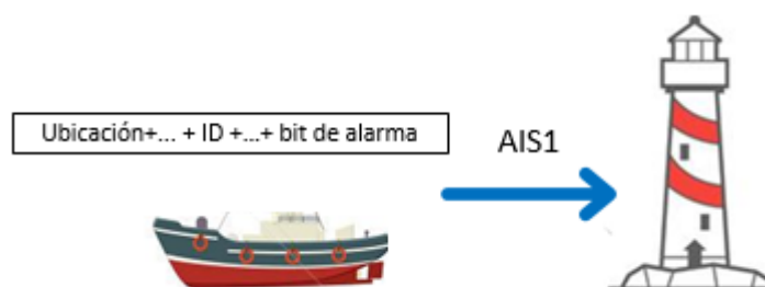
Figura 2.18: Diagrama de conexión de las embarcaciones con la estación costera
