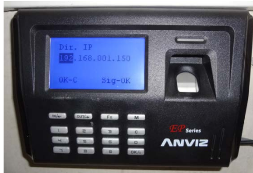
Figura 2.12 Control de acceso biométrico Anviz
