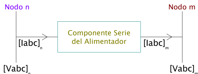
Figura 3.1: Modelo estándar de componentes serie de un alimentador [1].
