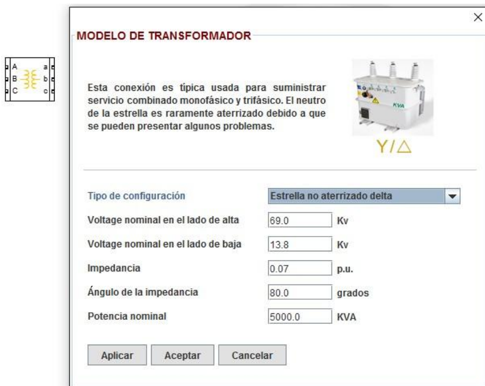
Figura 4.12: Interfaz gráfica del modelo de transformador Estrella no aterrizado-delta.
