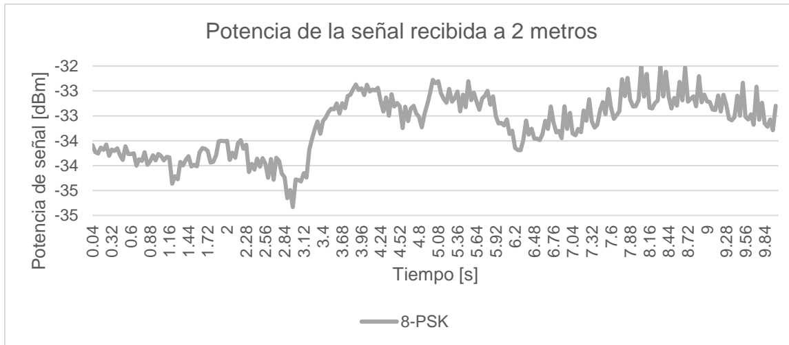
Figura 3.3 Potencia de la señal recibida a 2 metros para la modulación 8-PSK.
