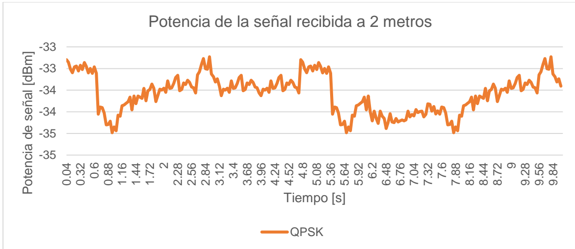
Figura 3.5 Potencia de la señal recibida a 2 metros en la modulación QPSK.
